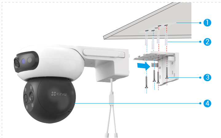
Fig. 1 Montage au plafond
